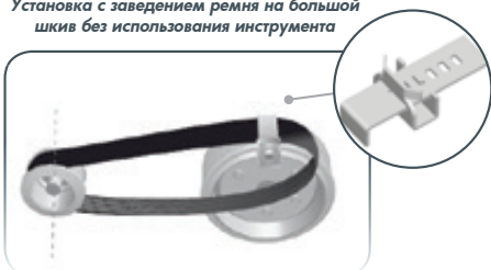
Установка с заведением ремня на большой шкив с использованием инструмента SNAP ON
